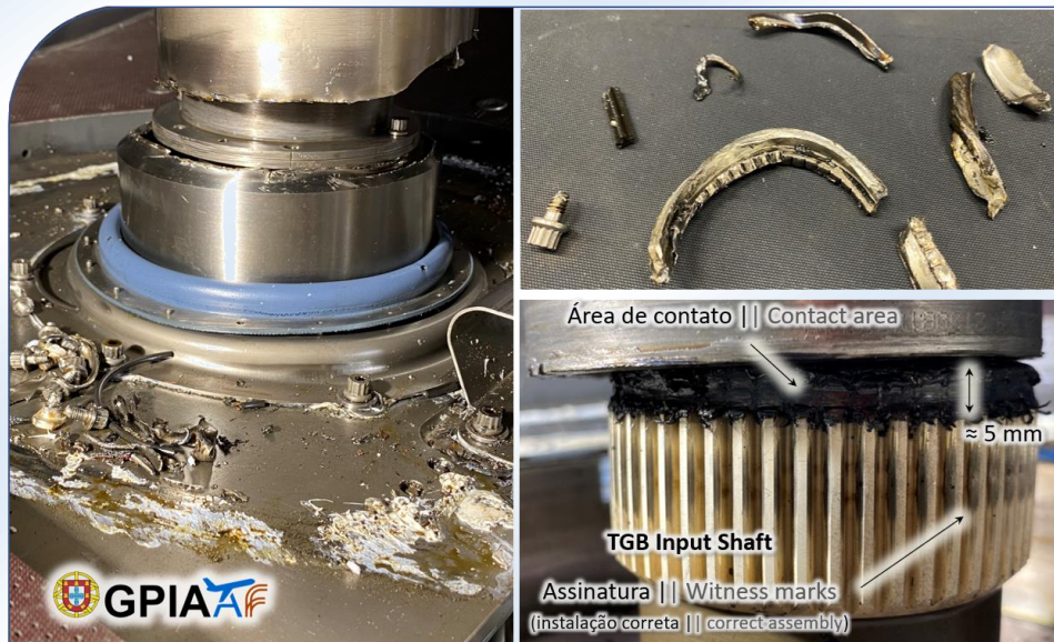
Figura 5 || Danos e detritos na base da proteção do veio e danos nas estrias do veio da TGB
